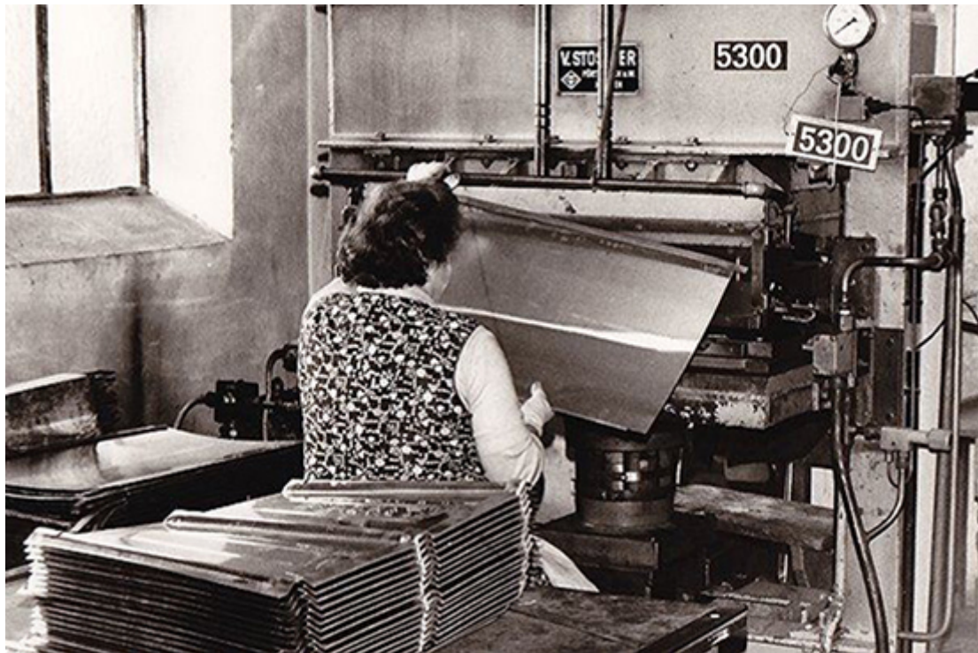
Herstellung der ersten PressFalzplatten aus Aluminium in der Firma von Alois Gödl, 1946
