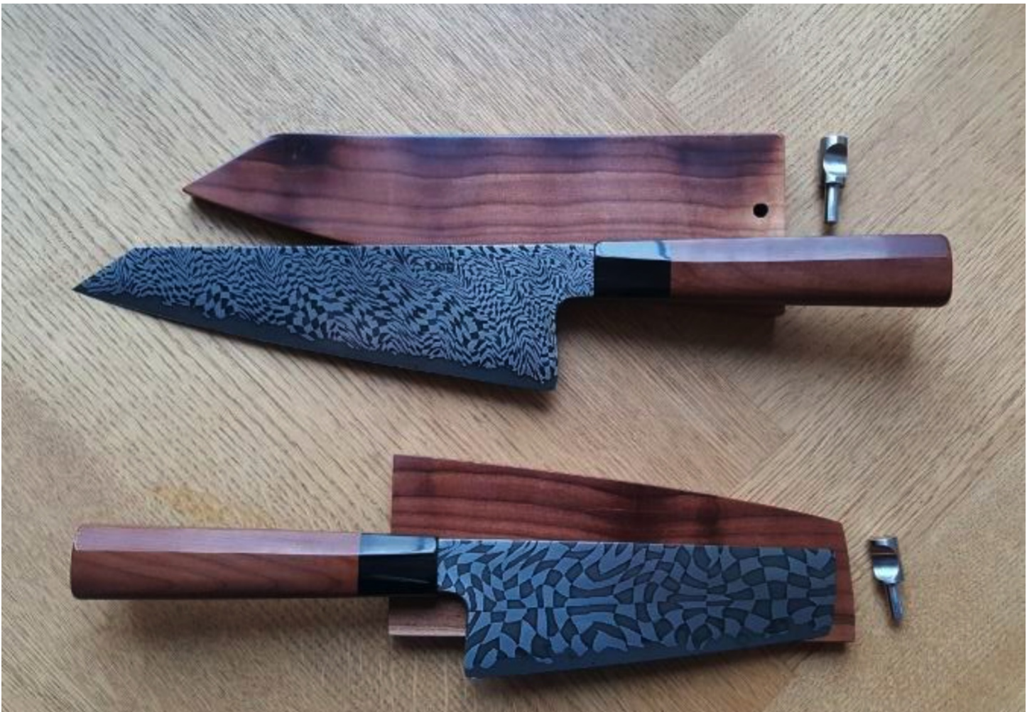
Mosaikdamastmesser, Messerschmiede Guldemann; Waldkirschholz für Griff und Messerscheide modifiziert zu Bijouwood durch Swiss Wood Solution.
