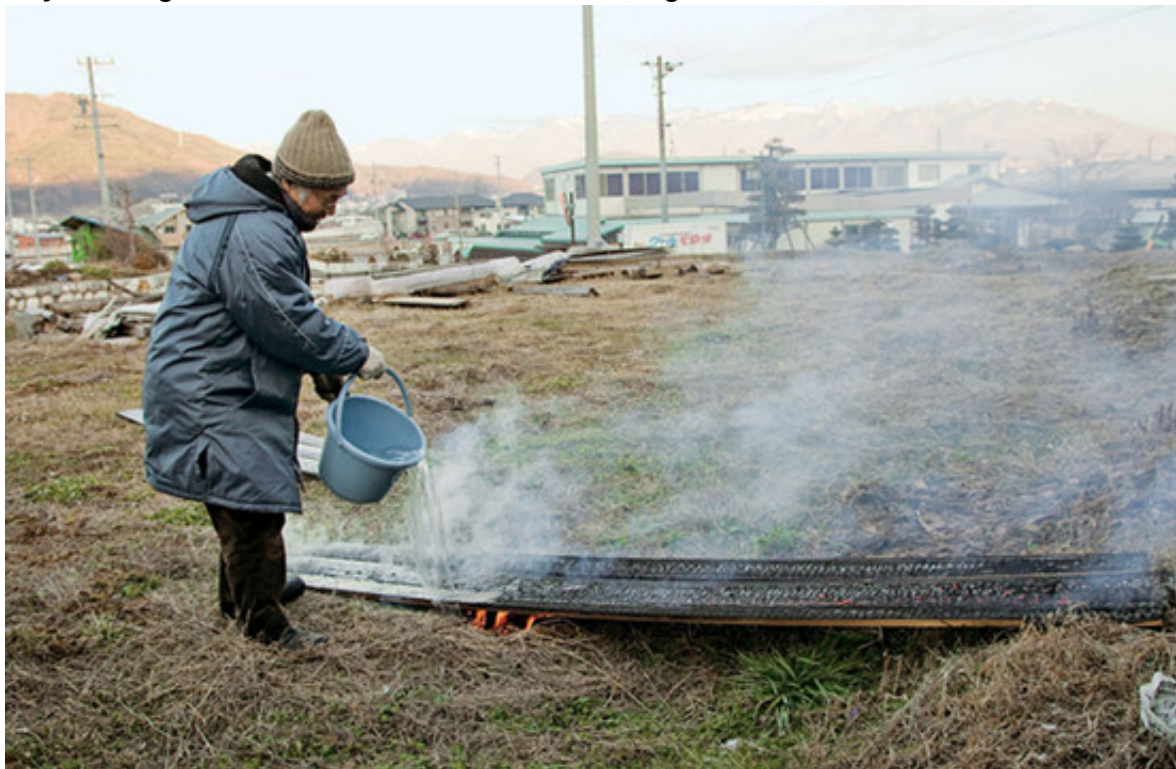
Verkohlung als natürliche Technik, Holz vor Witterung, Fäulnis und Insekten zu schützen.
