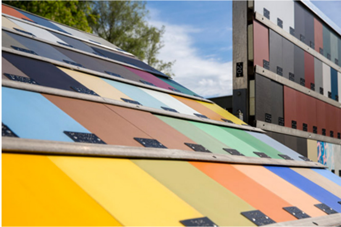
Langzeit Witterungsversuche auf dem Werkgelände in Niederurnen
