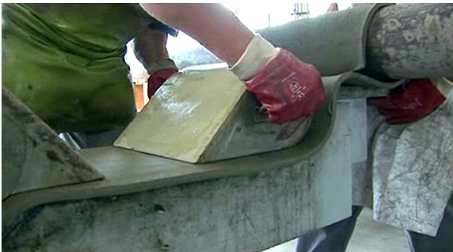
Fertigung eines Gartensessels, Entwurf Willy Guhl 1954, Handarbeit mit Stützform und Matrize.
