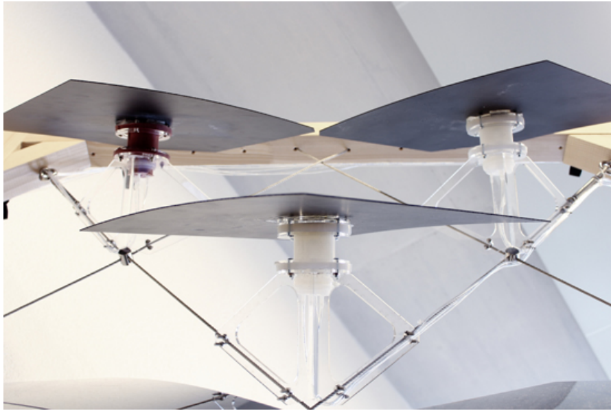
Soft Robotik steuert die einzelnen Elemente der Energiefassade
