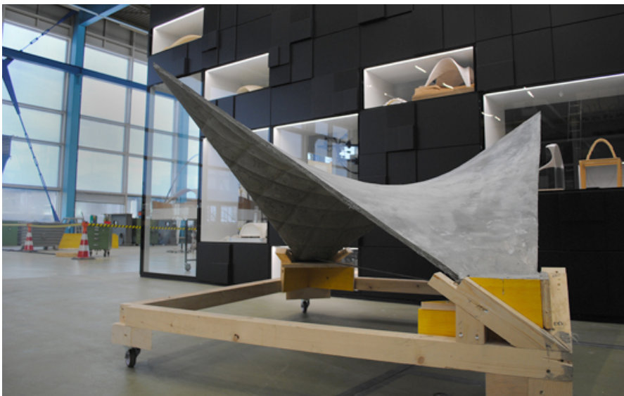
Nur wenige Zentimeter dick sind die Betonschalen des Dachs
