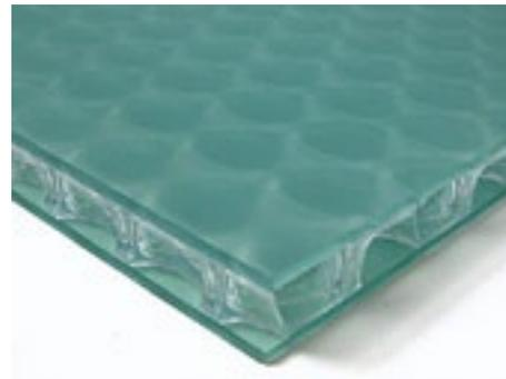
Neomat AG fertigt wetter- und lichtbeständige sowie schlagfeste Kunststoffe. Sie zeichnen sich durch eine vielfältige Optik und breite Einsatzmöglichkeiten aus. Mittels einer speziellen Klebertechnologie wird bei «Clear-Pep» ein bienenwabenähnlicher Kern mit transparenten, farbigen oder satinierten Deckschichten zu einem Panel verbunden. Die Elemente sind in den Grössen 2.55×1.05 m und 3.02×1.22 m erhältlich.
